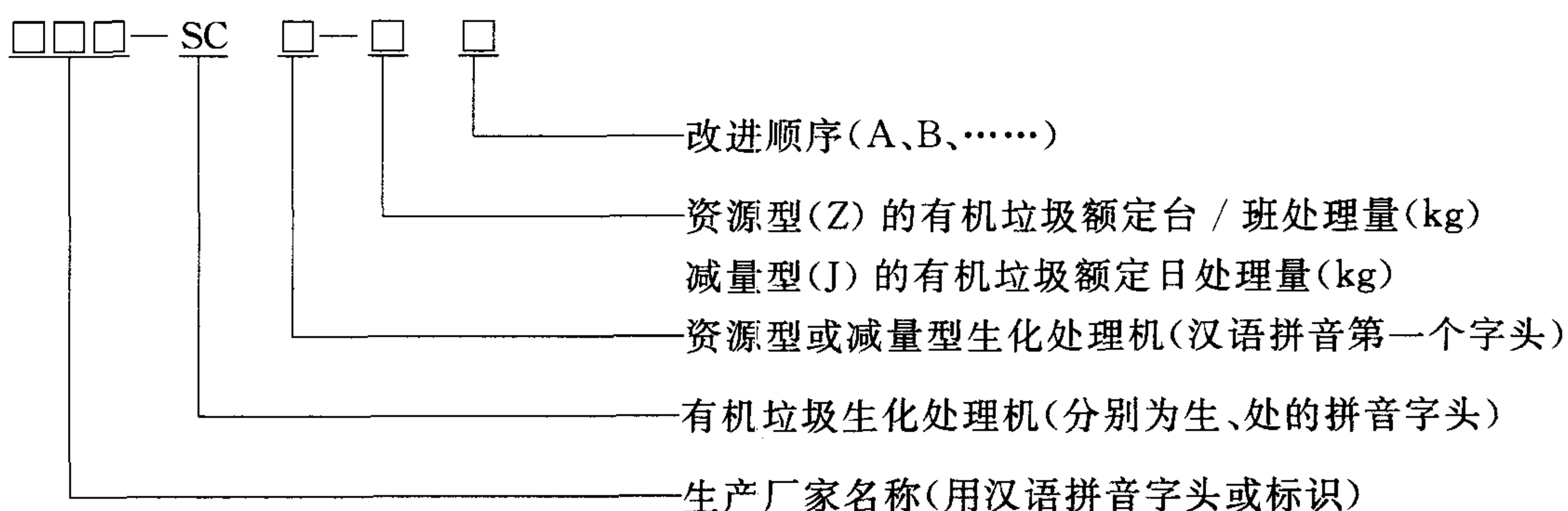
示例: ① FP-SCJ-100A 表示为有机垃圾生化处理机:减量型,额定日处理能力 100 kg,第一代产品,由 FP 公司生产。
